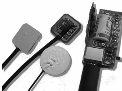
Obr. 2. Kompletné zariadenie na spracovanie signálov ECG s aktívnymi elektródami
